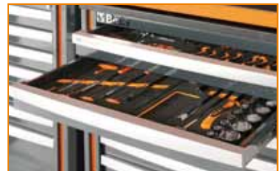
6 Gavetas podem ser equipadas com tabuleiros maleáveis (opcional)
