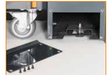
12 Pés ajustáveis para adaptação superfícies desniveladas
