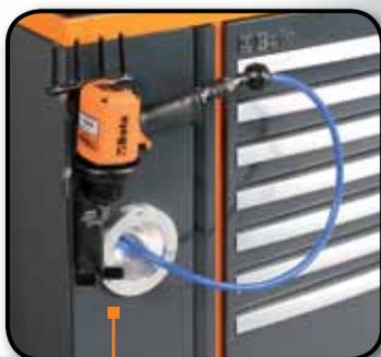
Bocal saída de ar comprimido com rolo Ø 8 mm.
